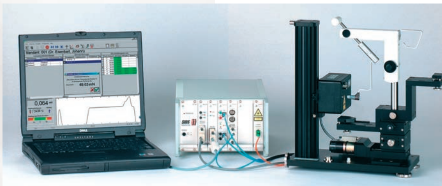
Bild 2. Bisher konnten Tonometer nur stationär kalibriert werden. Dies erfolgt jetzt mit einer mobilen interferenzoptischen Prüfeinrichtung direkt in der Arztpraxis
