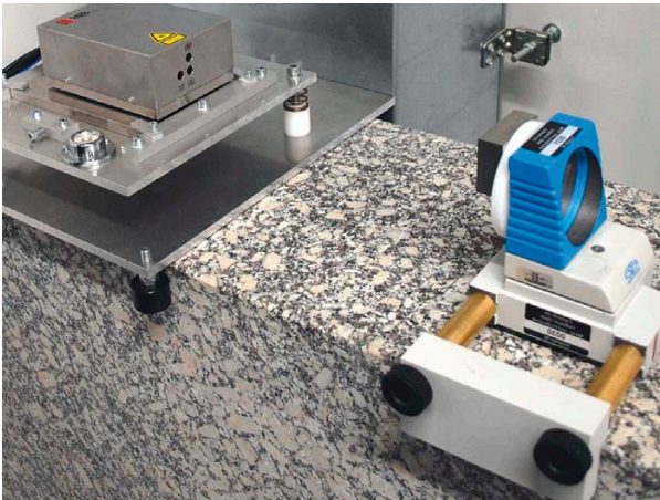
Bild 5: Messaufbau mit Verfahrslitten, Laserinterferometer und Granitbank
