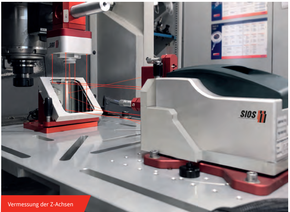
Kompakte Messung an einer hochgenauen Werkzeugmaschine
